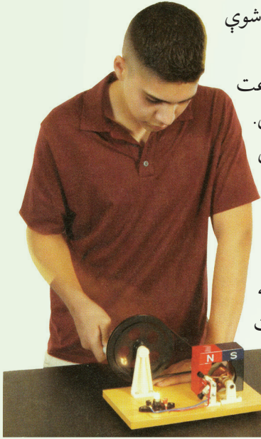
(9-18) شکل: په یو ساده جزراتور کې، په مقناطیسي ساحه کې د هادي حلقو څرخیدل، په حلقو کې د برېښنا متناوب بهیر تولیدوي.
