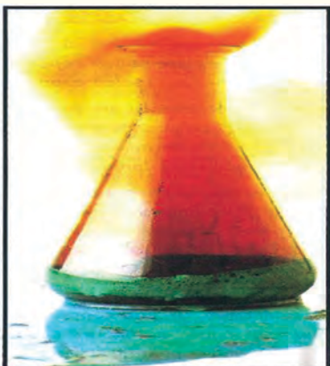
9 - 20 شکل، د مس تعامل د HNO_3 د غلیظ تیزاب سره
