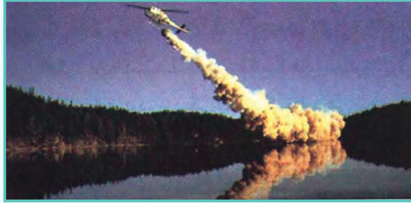
(11_13) شکل: د اسکانډینیا تیزابي سیند کې د چوني د ډبرو د پوډرو په واسطه د هغه د تیزابونو خنثی کول
