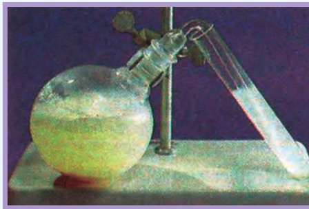
(6-8) شکل: د گلوکوز د تخمر د ستگاه او د ایتایل الکولو لاسته راوړل
