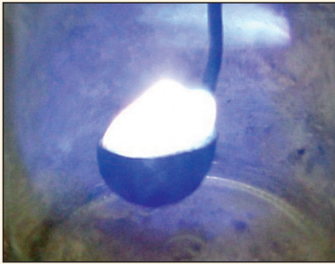
(۳-۵) شکل: د سلفر سوخیدل د سوخیدو په قاشوغه کې
