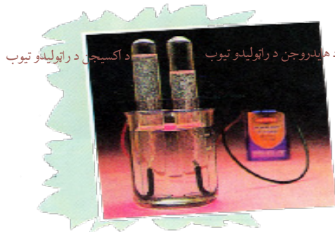
(۴-۴) شکل: د اوبو برېښنايي تجزیه
